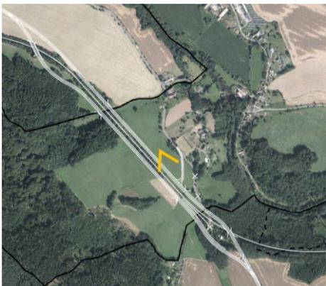
Od křížení podchodu žluté turistické trasy pod železnici a nově i pod silnicí již silnice pokračuje konstantně ve výškové úrovni železniční trati. Bezprostředně za křížením podchodu žluté turistické trasy je navrženo nové napojení stávající silnice III/29915 (přerušené nadjezdem nad železniční tratí) na navrhovanou silnici.
