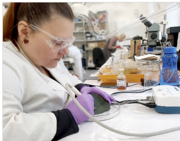
Bronzová faléra – čištění ultrazvukovým skalpelem
