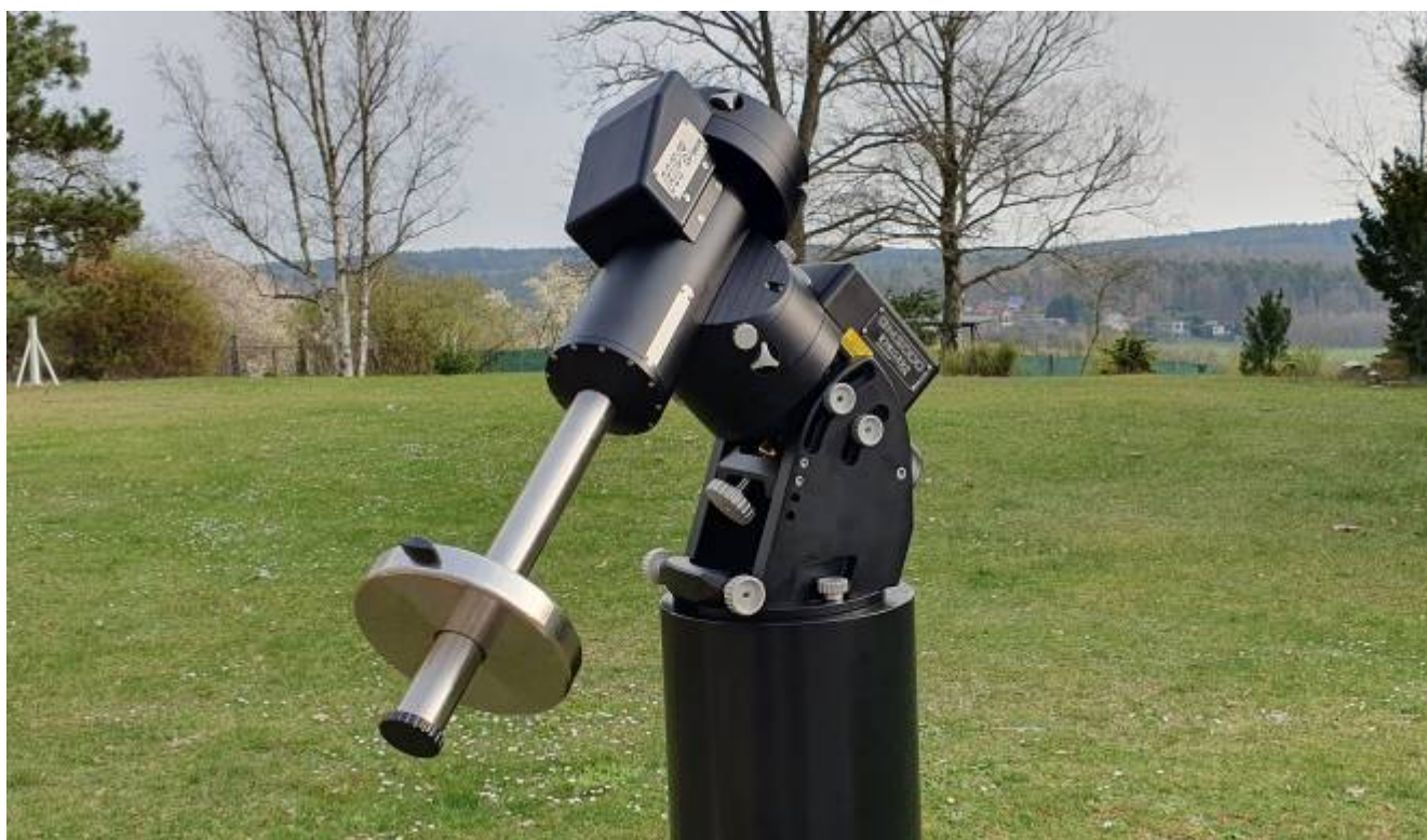
Paralaktická montáž GM-2000 HPS II combi s přístrojovou nosností do 50 kg pro stabilní i přenosné využití.
