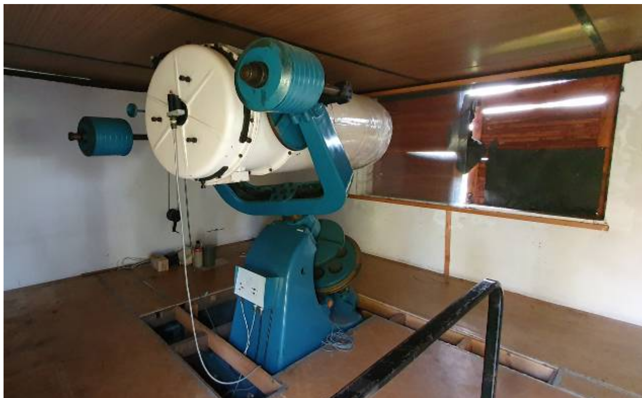
Schmidtova fotografická komora s paralaktickou montáží v objektu pozorovacího domku před zahájením stěhovacích prací.
