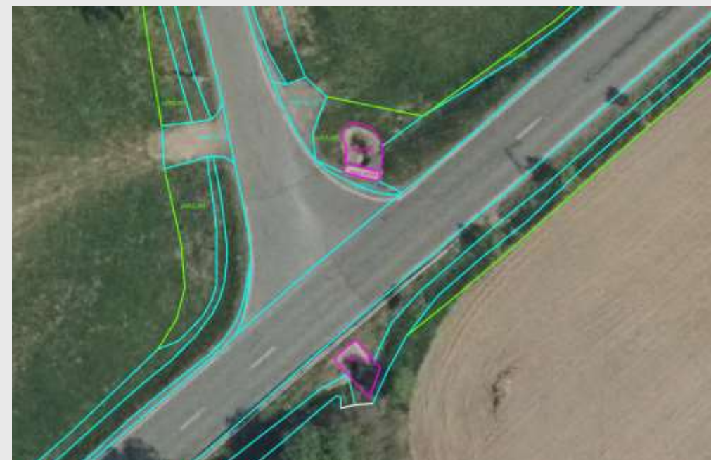
Ukázka DTM extravilánu (propustky)
